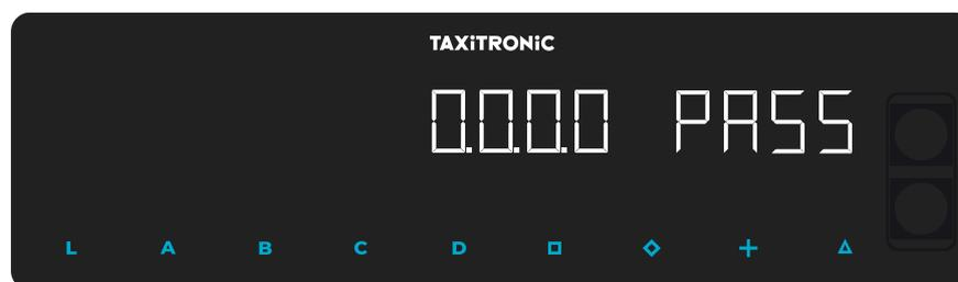
Dans le cas où un mot de passe est nécessaire, l'introduire en utilisant les touches **A, B, C** et **D** pour changer chacune des quatre positions. Valider en appuyant sur la touche **□**.
