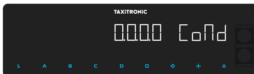
Introduire le numéro de Chauffeur utilisant les touches **A**, **B**, **C** et **D** pour changer chacune des quatre positions. Valider en appuyant sur la touche
