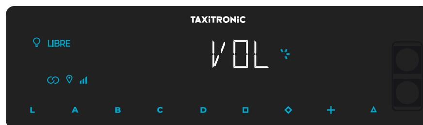
Appuyer sur la touche **□** pour régler le volume du son du clavier, l'indicateur circulaire indique l'intensité sélectionné.
