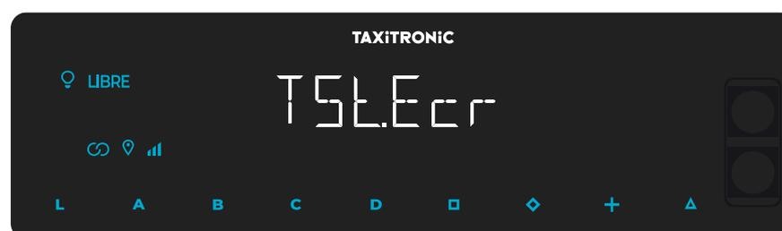
Appuyer sur la touche **□** pour réaliser la séquence de test (0,1, ..., 9.)
