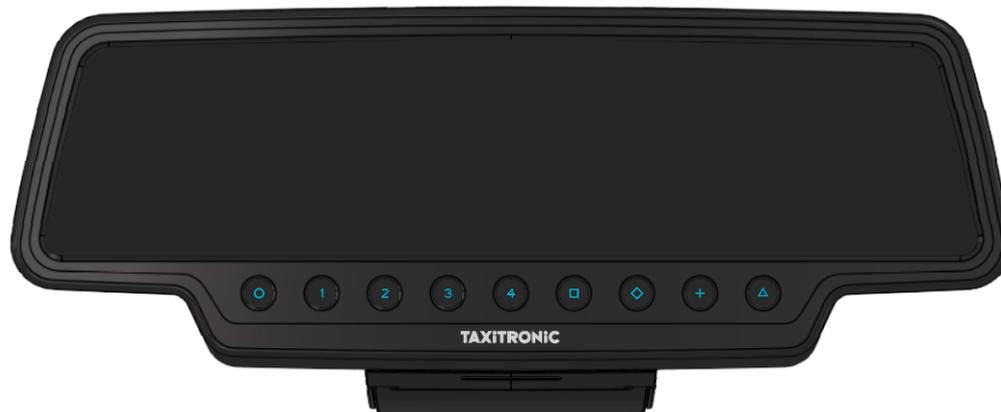
Carregar na tecla **O** para passar a ON. Se existir um código de acesso programado, o segundo ponto decimal do display do estado acende-se intermitentemente indicando que se espera a introdução do código correto.
