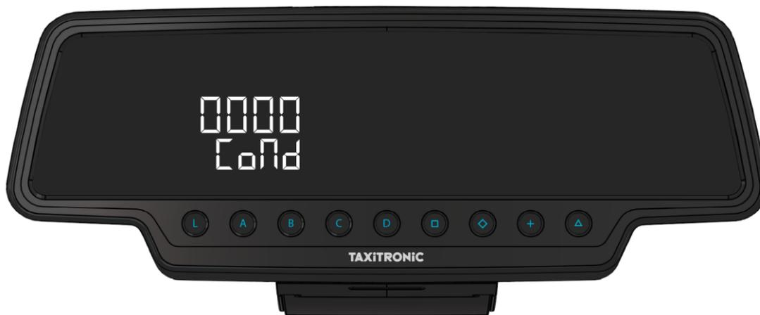
Introduire le numéro de Chauffeur utilisant les touches **A, B, C** et **D** pour changer chacune des quatre positions. Valider en appuyant sur la touche
