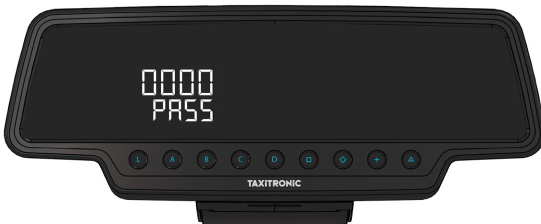
Dans le cas où un mot de passe est nécessaire, l'introduire en utilisant les touches **A, B, C** et **D** pour changer chacune des quatre positions. Valider en appuyant sur la touche
