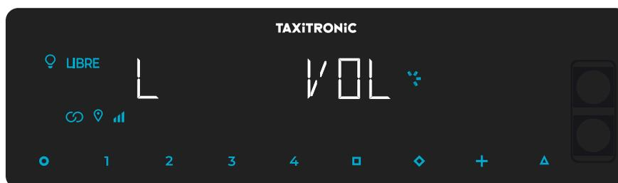
Pulsando la tecla **□** para regular el volumen del zumbido. El indicador circular muestra la intensidad seleccionada.
