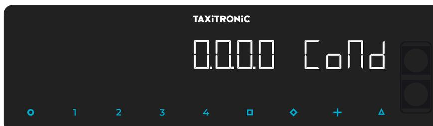
Introducir el número del Conductor utilizando las teclas **1, 2, 3 y 4** para cambiar cada una de las cuatro posiciones. Validar pulsando la tecla **□**.
