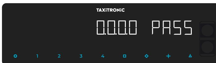
En caso de necesitar contraseña, introducirla utilizando las teclas **1, 2, 3 y 4** para cambiar cada una de las cuatro posiciones. Validar pulsando la tecla **□**.
