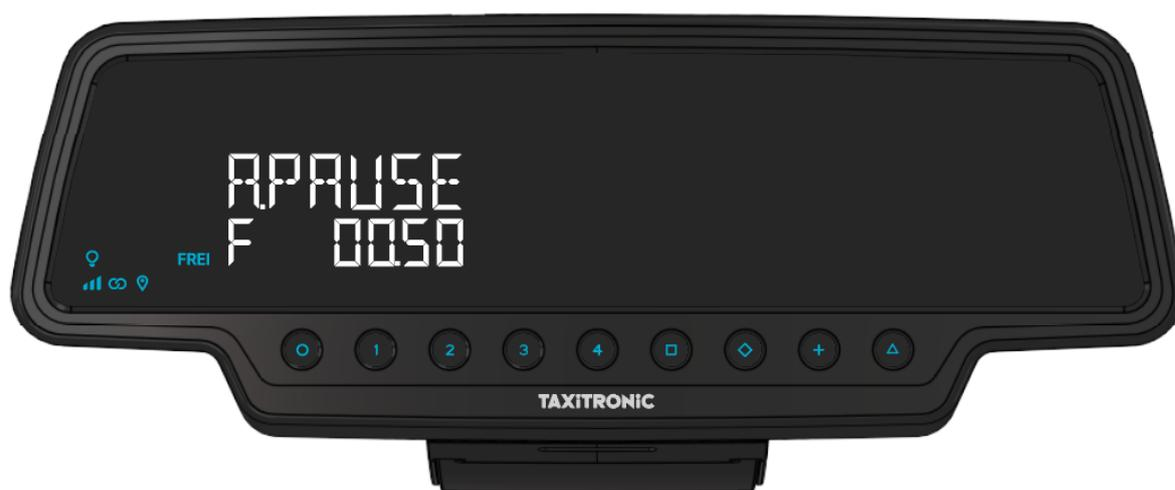
Aus der manuellen Pause kommt man heraus, indem man die **O** Taste betätigt, oder das Fahrzeug bewegt wird.
