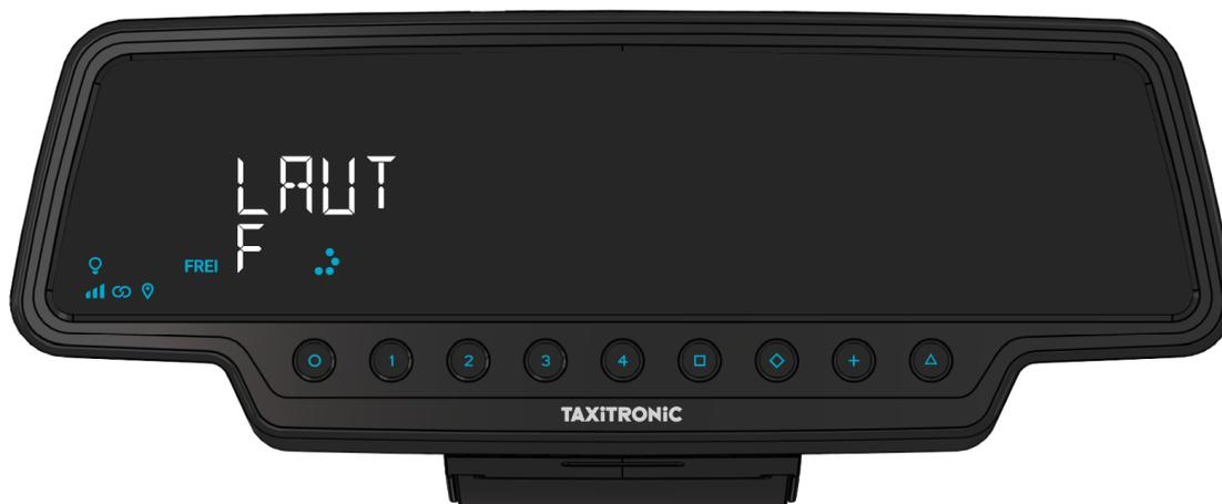
Mit Betätigung der Taste
