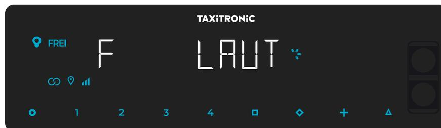
Mit Betätigung der Taste **□** können Sie die Lautstärke des Tons bei Tastenbetätigung einstellen. Der Kreis zeigt die ausgewählte Intensität an.
