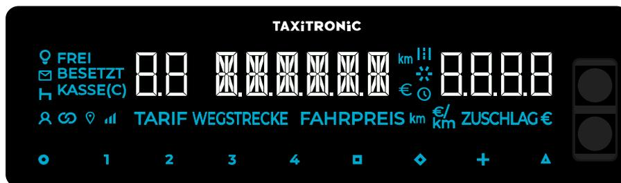
Bevor der Taxameter in den Status „Frei“ geht wird, für die Dauer von 3 Sekunden, ein Display-Test angezeigt.
