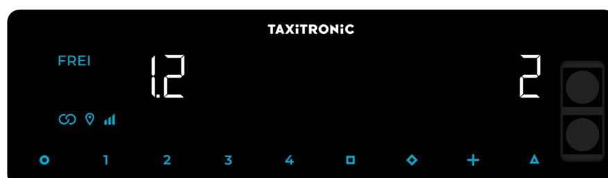
Nach der Anzeige aller Tarifdaten werden u.a. Programmversionen und deren Prüfsumme, sowie Aktualisierungsdatum angezeigt.
