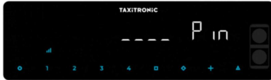
Die PIN wird mit den Tasten **1 – 2 – 3 – 4** eingegeben und mit **□** bestätigt.
