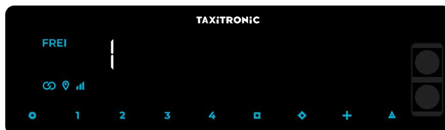
Durch erneutes Drücken der Taste **◇**, oder nach einigen Sekunden wird der Wert des nächsten Gesamtzählers angezeigt. Die Anzeige der Gesamtzähler kann jederzeit mit der Betätigung der Taste **○** beendet werden.
