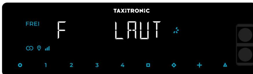
Mit Betätigung der Taste **□** können Sie die Lautstärke des Tons bei Tastenbetätigung einstellen. Das Symbol **\*** zeigt die ausgewählte Intensität an.
