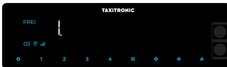
Durch erneutes Drücken der Taste
